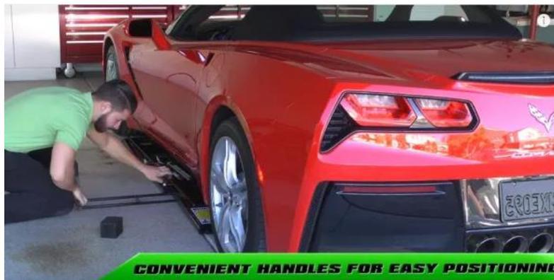
Étape 6 – Placez les blocs caoutchoucs de levage sur les rampes.
