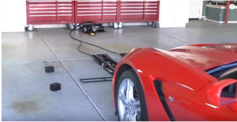
Étape 5 – Utilisez les supports pour tirer les rampes sous votre seuil ou poussez les sous le seuil à partir de l'extérieur.
