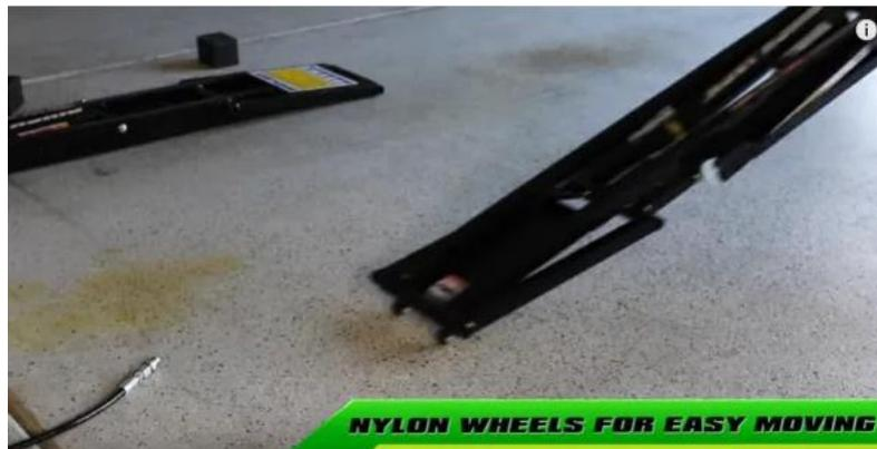
Étape 4 – Garez votre véhicule au-dessus ou entre les QUICKJACK de sorte que les rampes soient situées au niveau des seuils.
